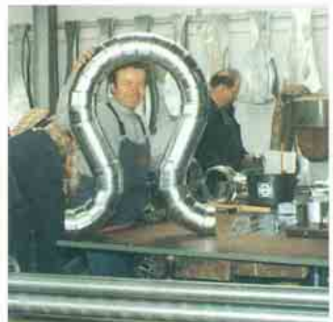
Vorfertigung eines Dehnungsbogens
