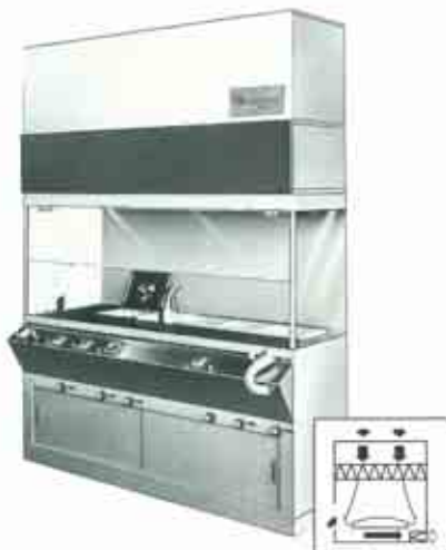
Das Bild zeigt eine Prozeßwerkbank, wie sie von KAEFER gefertigt und montiert wird. Solche Prozeßwerkbänke eignen sich für chemische Naß- und Trockenprozesse. Sie sind säure- und laugenbeständig. Die Anlagen werden den Erfordernissen des jeweiligen Anwendungsbereiches in Chemie, Elektronikfertigung, Optik oder Forschung angepaßt. Sie enthalten prozeßspezifische Einbauten; die Arbeitsplätze werden kontrolliert entsorgt.
