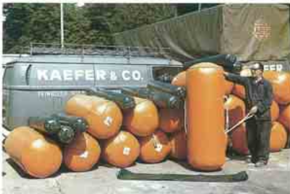
Lieferwagen 1967, davor mit Polyurethan ausgeschäumte Schwimmkörper
