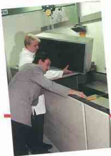
Einbau von Schalldämpferkulissen in den Prüfkanal
