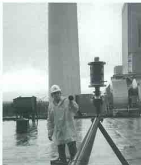
Hauke Mütel bei einer Vormessung (Grundgeräusch) im Kraftwerk Hafens, Bremen
